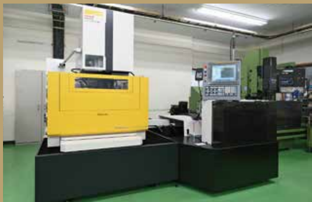
a-C800iB ワイヤー放電加工機 (FANUC) 800×600×500
