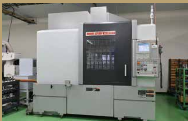
NVX5100 II /50 縦型マシニングセンター (DMG MORI) 1050×530×510
