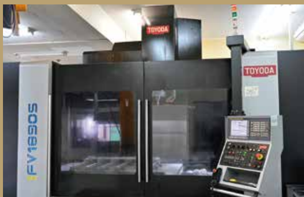
FV1890S 縦型マシニングセンター (JTEKT(Toyoda)) 1800×900×900
