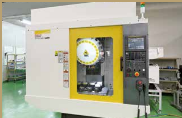
ROBODRILL α-D21LiB5 Plus 縦型マシニングセンター (FANUC) 700×400×330 主軸24000回転
